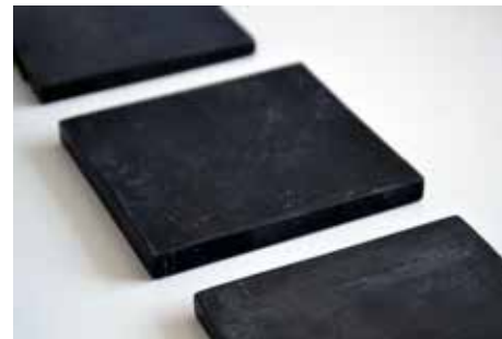
Образцы термостойкого радиопрозрачного материала на основе полиимидов
