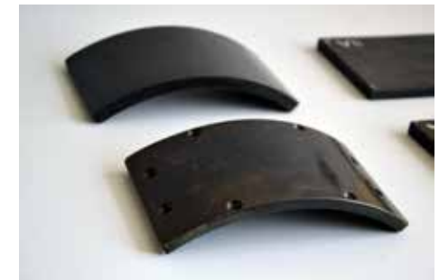
Образцы термостойкого радиопрозрачного материала на основе полиимидов
